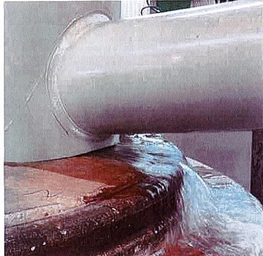
Die Schweißnaht zwischen Schachtrohr und Bodenplatte unterhalb des Anschlussrohres war über eine Länge von ca. 15 cm bei beiden Schächten gerissen. An der Schweißnaht zwischen Schachtrohr und Anschlussrohr konnten keine Schäden festgestellt werden.
